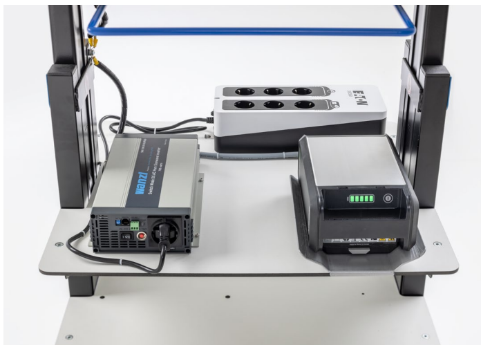
Der leistungsstarke Li-Ionen-Akku (Zubehör) liefert ausreichend Energie um mehrere Peripheriegeräte gleichzeitig zu betreiben.
